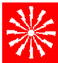
PULSANTE DI ALLARME ANTINCENDIO
