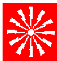
PULSANTE DI ALLARME ANTINCENDIO
