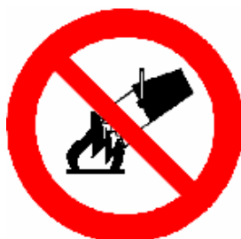
VIETATO SPEGNERE CON ACQUA
