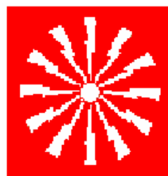
PULSANTE DI ALLARME ANTINCENDIO
